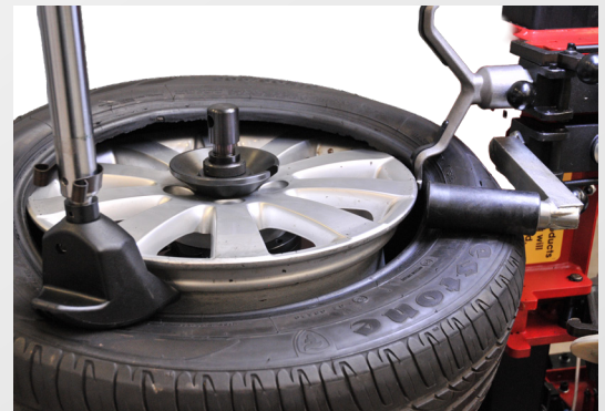
PNEUMATISCHER ANDRUCKARM + SERIENMÄSSIGE ANDRUCKROLLE
